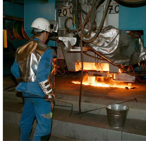
Abbildung 1: Links: Schematische Darstellung einer Stranggussanlage. Rechts: Blick in die Kokille einer Stranggussanlage der voestalpine Stahl GmbH (Quelle: www.expeditionvoestalpine.com )
